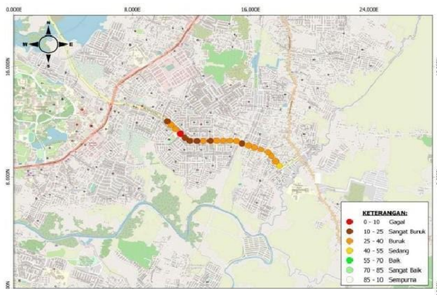
Gambar 2 Peta Kondisi Jalan Arah Keluar Desa Ridan Permai
