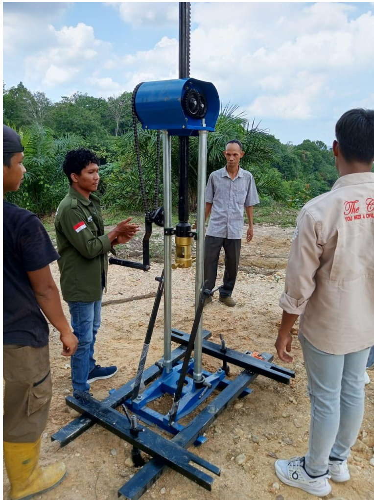
Gambar 4. Alat uji sondir kapasitas 2,5 Ton
