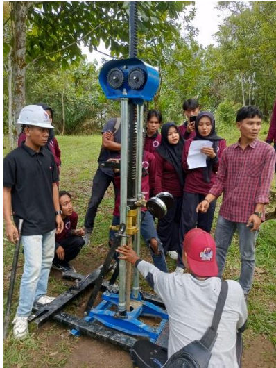
Gambar 5. Pelaksanaan kegiatan pengabdian. (a) Mahasiswa teknik sipil Universitas Pahlawan (b) Pemasangan jangkar sondir.
